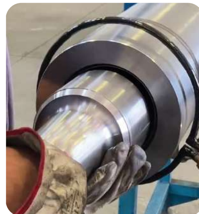
Smršťování válce pro hydraulické písty Indukční smyčka L20/D200 Powerduction 220LG
