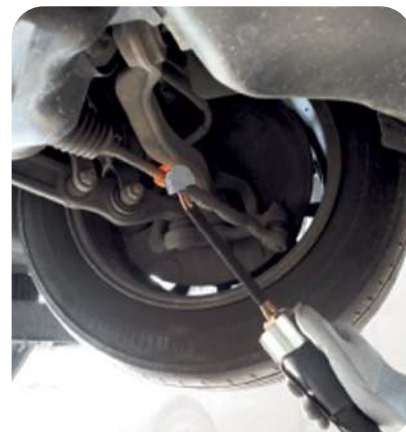
Uvolnění řízení spojovacích tyčí Induktor Small S20/B1
