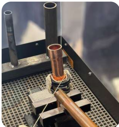
Sestavení měděných dílů Induktor BRAZ L90 Powerduction 220LG
