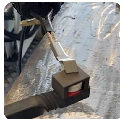
Ohřev ocelových tyčí: Induktor 10R/B5 - Powerduction 10R
