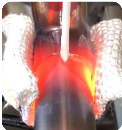
Pájení s tyčinkou na spojku Ø28 Induktor BRAZ L90
