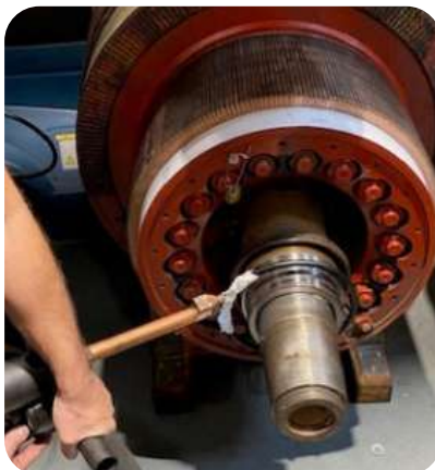
Vyjmutí kroužků z elektrického motoru Indukční smyčka L20/D200 Powerduction 220LG
