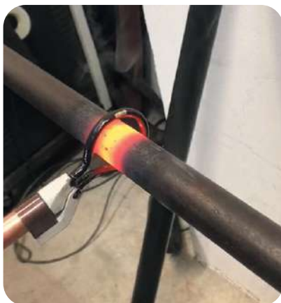
Ohýbání ocelové trubky Induktor smyčky S180/D20
