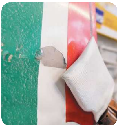
Odstranění samolepek Induktor L20 Alu Glove
