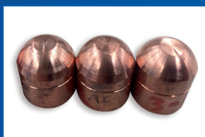
Pro frézování standardních i speciálních tvarů elektrodových čepiček
