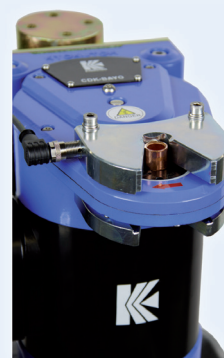
■ Navádění pro robotické a ruční kleště
