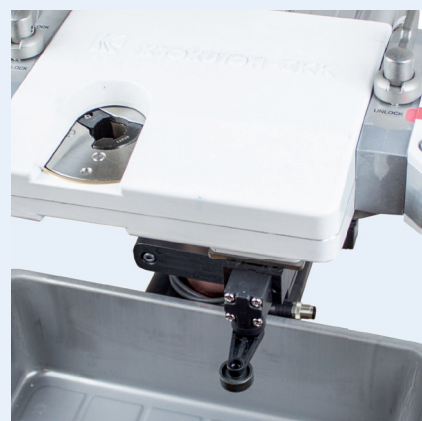
■ Kontrola přítomnosti čepičky pomocí koncového spínače
