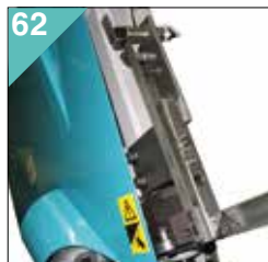
62 Zařízení pro kontrolu kolmé osy a přesnosti pilového pásu
