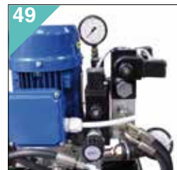
49 Jeden redukční ventil pro hydraulický svěrák
