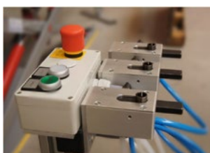
Podavač svorníků s pneumatickou distribucí
