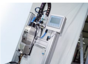
Navařovací hlava s měřením vzdálenosti pro snadné nastavení a kontrolu
